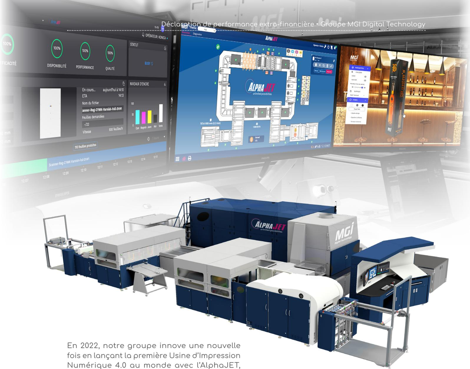
En 2022, notre groupe innove une nouvelle fois en lançant la première Usine d'Impression Numérique 4.0 au monde avec l'AlphaJET, permettant de réaliser, en un seul calage, les opérations d'Impression, de dépose de vernis sélectif et de dorure à chaud, sur des feuilles de papier et de carton au format 72x110.
