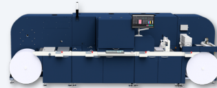
configuration #1 : moteur principal Unwinder / Scanner / Main Printer / Rewinder
