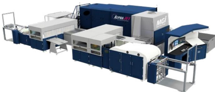
L'AlphaJET est une innovation de rupture dans l'imprimerie industrielle, qui intègre pour la première fois, en un seul passage, et selon un flux 100% numérique, toutes les étapes d'impression quadri, de dépose d'un vernis sélectif UV et d'une dorure à chaud, en données fixes ou variables, en 2D et 3D, dans un format B1 (72x110cm).
