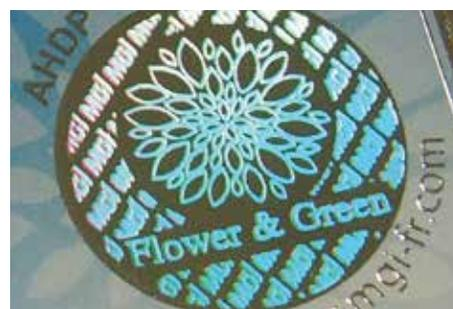
Il est possible de réaliser de la dorure à chaud sur l'**iFOIL** à partir de travaux imprimés en offset, en flexo ou en numérique. Le film de dorure peut se déposer sur le papier brut, sur une lamination, ou sur un vernis acrylique.
